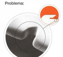
Fios de poliéster causam profundas cavas em um curto período de tempo - o que significa substituição frequente de platinas!
